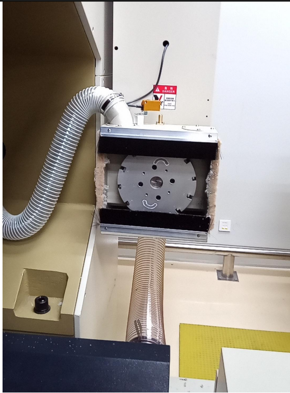
磨边机配套集气管道（设备自带密闭集气）
