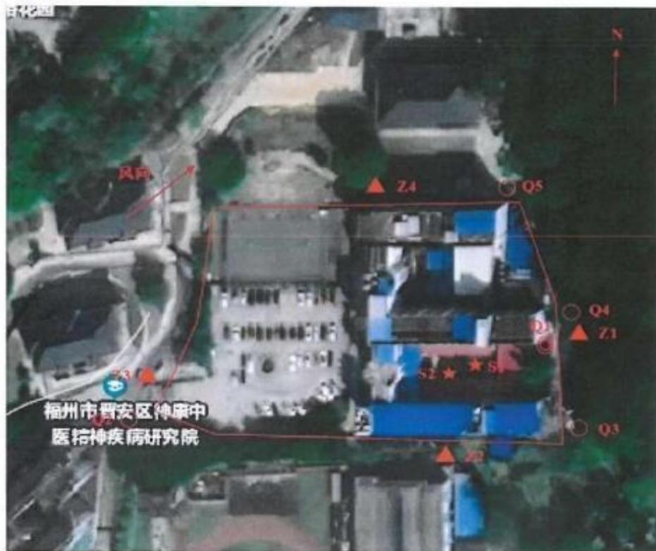
★—废水监测点位；⊙—有组织废气监测点位；⊘—无组织废气监测点位；▲—厂界噪声监测点位
