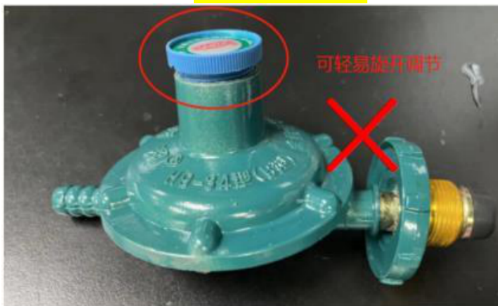
调压部件未封固的调压器
